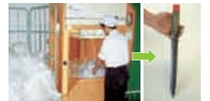
ストレッチフィルムを圧縮して→測量用の杭に
